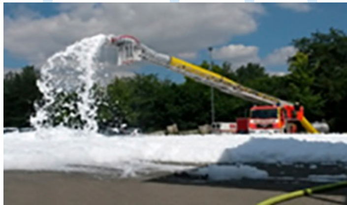
Fotografía 4: Aplicación alta expansión desde escalera mecánica.
